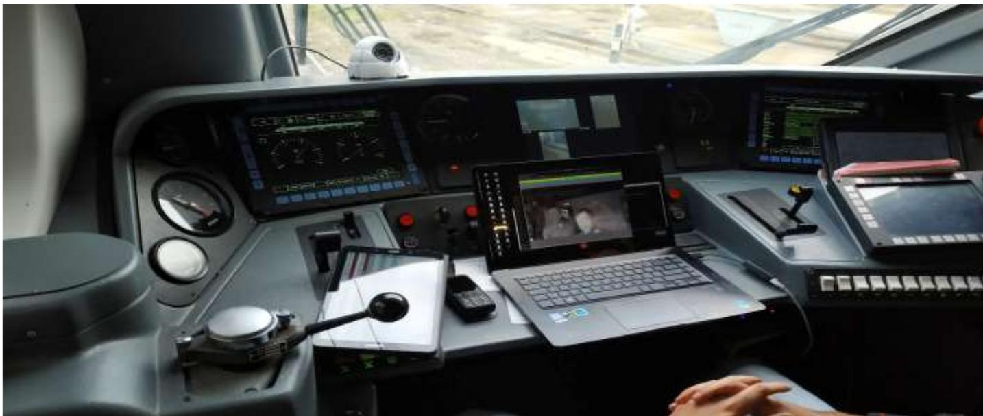
La DT di Trenitalia ha illustrato l'architettura del dispositivo, che consiste in una telecamera di sorveglianza ad infrarossi, collegata alla centralina che elabora le immagini con algoritmi ottimizzati per rilevare il battito delle ciglia dell'agente di condotta. Rilevato il battito invia un segnale alla centralina delle reiterazioni.
